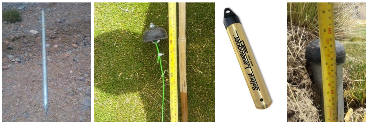
Fotografías 9 a 12. Tubo piezométrico, tapa y cordón de sujeción, sensores de nivel, tubo instalado.
