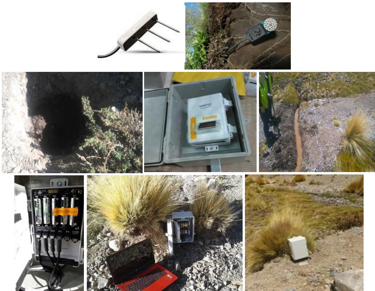
Fotografías 13 a 20. Sensores para determinación de humedad y potencial mátrico.
