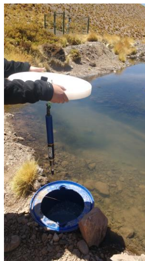
Fotografías 7 y 8. Sonda calidad de agua y sonda instalada.
